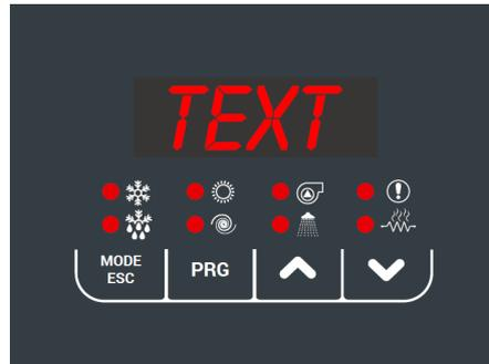
Die 4-stellige 7-Segmentanzeige visualisiert in der Regel die Kontrolltemperatur in Zehntel Grad Celsius oder den Alarmcode, wenn mindestens einer aktiv ist. Im Menümodus ist die Anzeige abhängig von Ihrer Position. Labels und Codes werden verwendet, um dem Benutzer zu helfen, die Art der eingestellten Visualisierung zu identifizieren.
